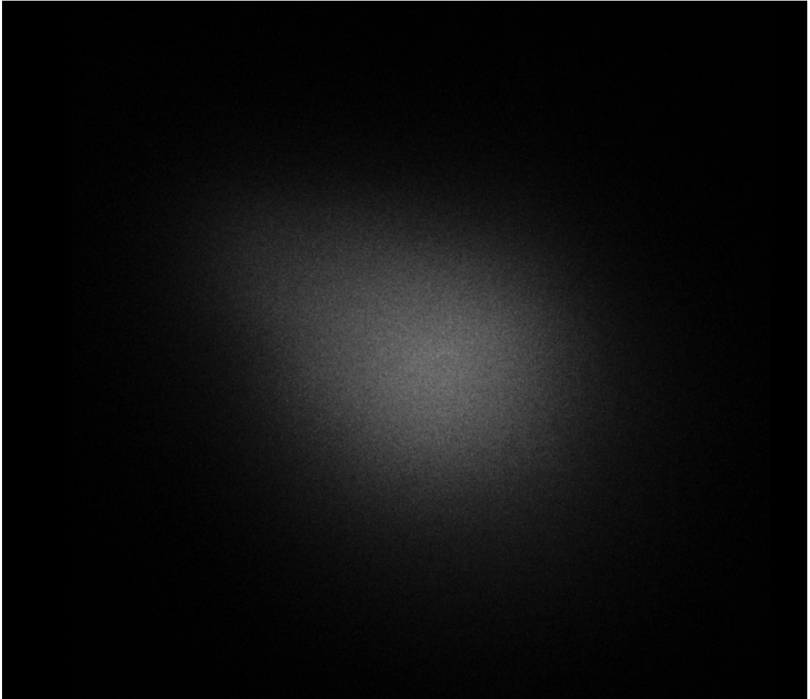
Slika 3.4: Fotografija oblaka hladnih atoma. Promjer oblak iznosi približno 1 mm.
