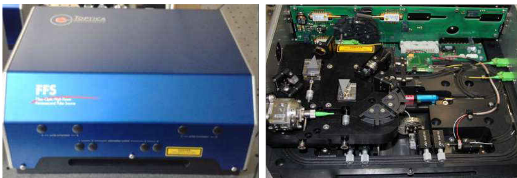
Slika 3.13: Femtosekundni laser s erbijem dopiranim optičkim vlaknom. Desno je prikazana unutrašnjost tog lasera.
