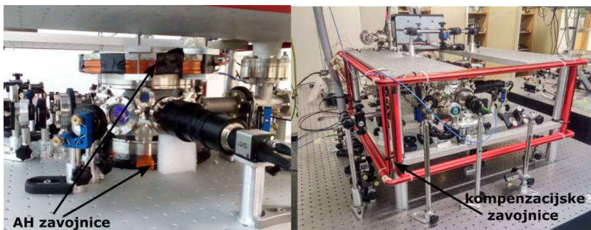
Slika 3.10: Prikaz anti-Helmholtz i kompenzacijskih zavojnica korištenih pri realizaciji magneto-optičke stupice.
