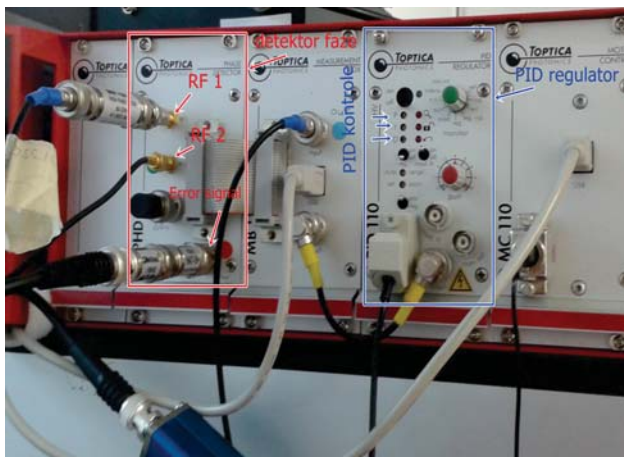
Slika 5. Detektor faze i PID kontroler. Prikazani su ulazni signali RF1 i RF2, error signal te PID kontrole
